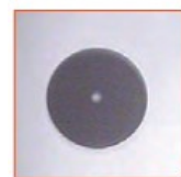
Dół: prawidłowo oczyszczona powierzchnia złączki.
